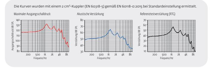
Aufgrund der komplexen Signalverarbeitung sind die Messungen der dargestellten Kurven nur in Standardeinstellungdes Gerätes und unter Verwendung der aktuell gültigen Softwareversion möglich. Wirkungen der einzelnen Parameter siehe Software.
