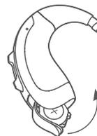
Anschließend setzen Sie die Batterie in das Batteriefach ein. Achten Sie dabei darauf, dass die Markierung (+) an der Batterie mit der Markierung (+) auf dem Batteriefach übereinstimmt.
