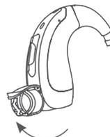
Öffnen Sie das Batteriefach vorsichtig mit dem Fingernagel an der dafür vorgesehenen Kante oder drücken Sie den Ein-/Aussschalter am Batteriefach bis dieses aufspringt und schwenken es vollständig heraus.
