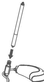
Los receptores incorporan un filtro CeruStop que protege el receptor de posibles obstrucciones. El filtro CeruStop debe sustituirse a intervalos periódicos.
