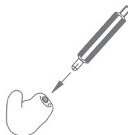
Para ello, utilice el aplicador, que contiene un nuevo filtro. Inserte el lado con el gancho en el filtro usado. Extraiga el filtro con cuidado.
